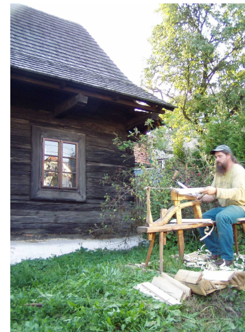
Šindele na opravu střechy vyráběli místní řemeslníci tradiční technologií.
